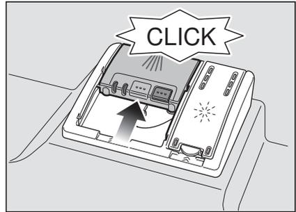
依洗涤程序的设置，洗涤剂槽会自动在正确的时间开启。粉状或液状洗涤剂会散布并溶解在洗碗机内。锭剂会落入机器内并在此溶解。
