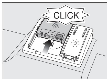
依洗涤程序的设置, 洗涤剂槽会自动在正确的时间开启。粉状或液状洗涤剂会散布并溶解在洗碗机内; 洗碗块会落在锭剂收集盘上, 并在此溶解。
